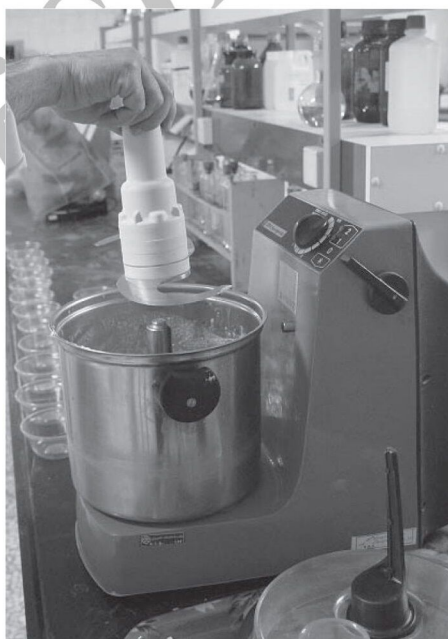
شکل ۷- همزن تیغه دار برای ایجاد نیروی برشی و خامه ای کردن بافت (۱).
